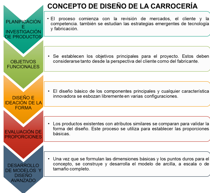
Figura 21. Diagrama sobre el concepto de diseño de una carrocería
