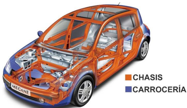
Figura 3. Diferencia entre chasis y carrocería
