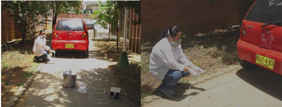
**Figura 18.** Muestreo de gases del tubo de escape de un automóvil, operado con gasolina.
