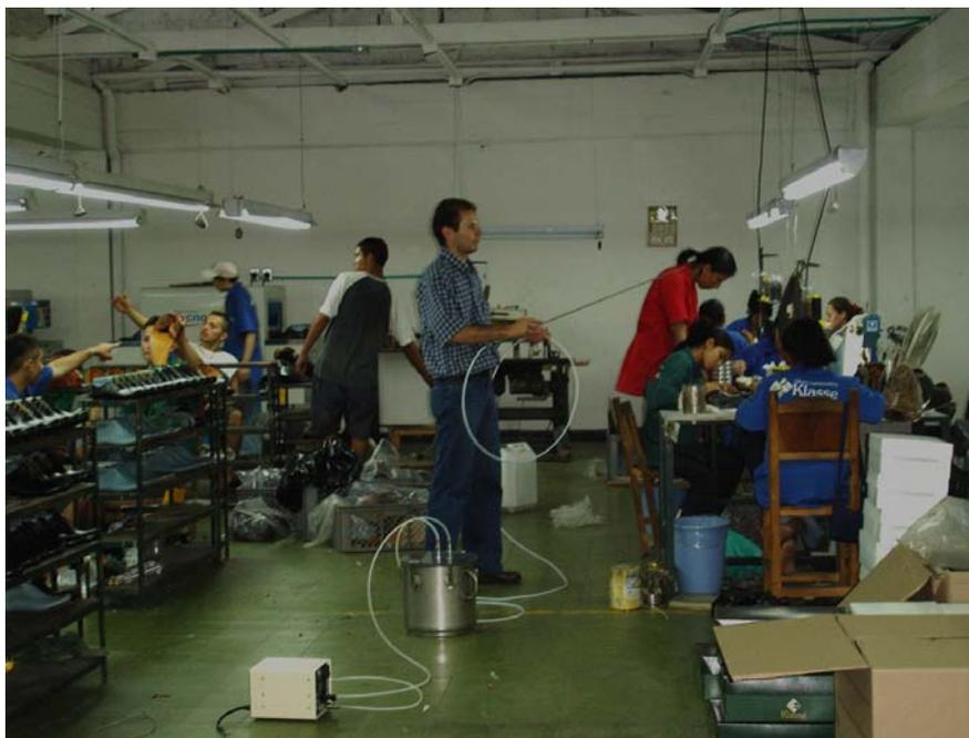
**Figura 15.** Muestreo de aire al interior de una fábrica de calzado (Bucaramanga, Santander).
