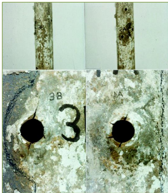
Figura 11. Cañón perforado por una bala durante prueba en superficie
