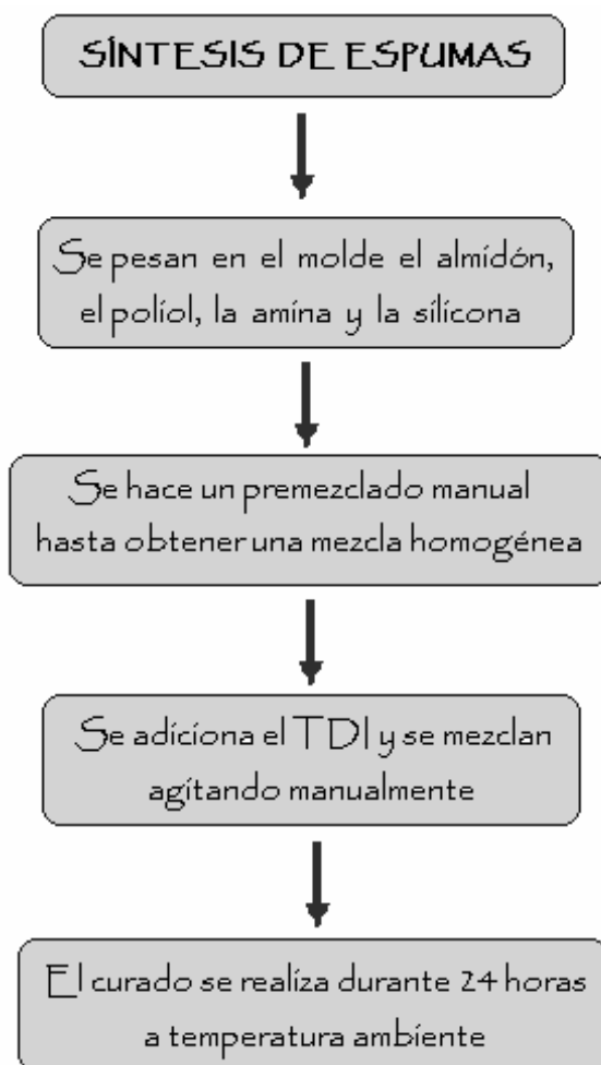
Figura 11. Diagrama del procedimiento utilizado en la síntesis de espumas
