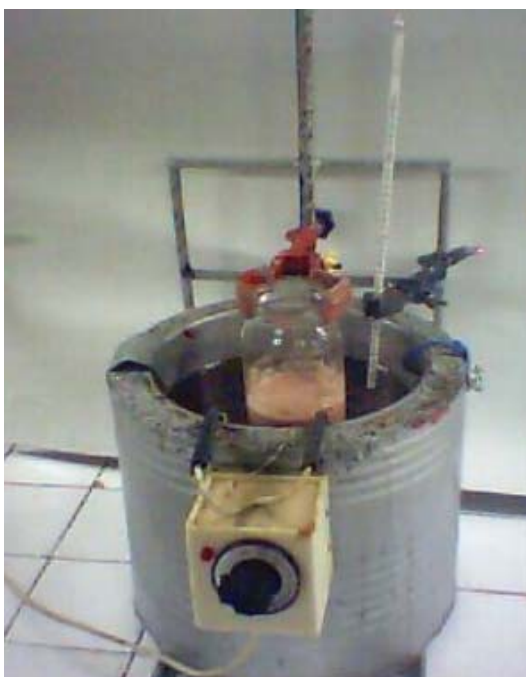
Fotografía 1. Montaje de la reacción de hidrólisis del almidón
