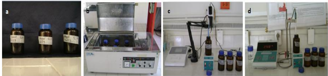
Figura 13. a) Muestras de \text{Cr}^{+3} y \text{Ni}^{+2} . b) Muestras de \text{Cr}^{+3} y \text{Ni}^{+2} en el Sheaker. c) Peachímetro con muestras de \text{Cr}^{+3} y \text{Ni}^{+2} d) Conductímetro con muestras de \text{Cr}^{+3} y \text{Ni}^{+2}
