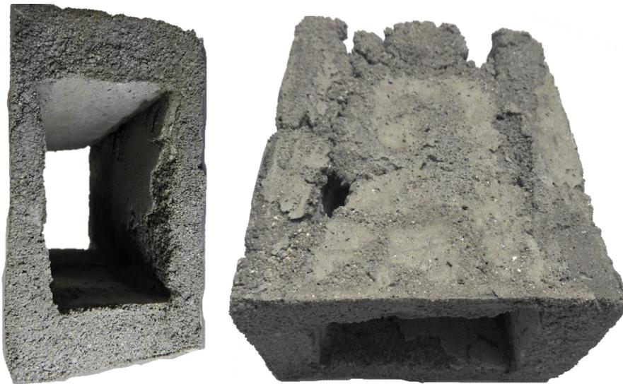
Luego, se procede a realizar un bloque mediante un alma en icopor, para ello se recortan cuatro laterales, se agrega la mezcla en ellos que va a ser el interior del
