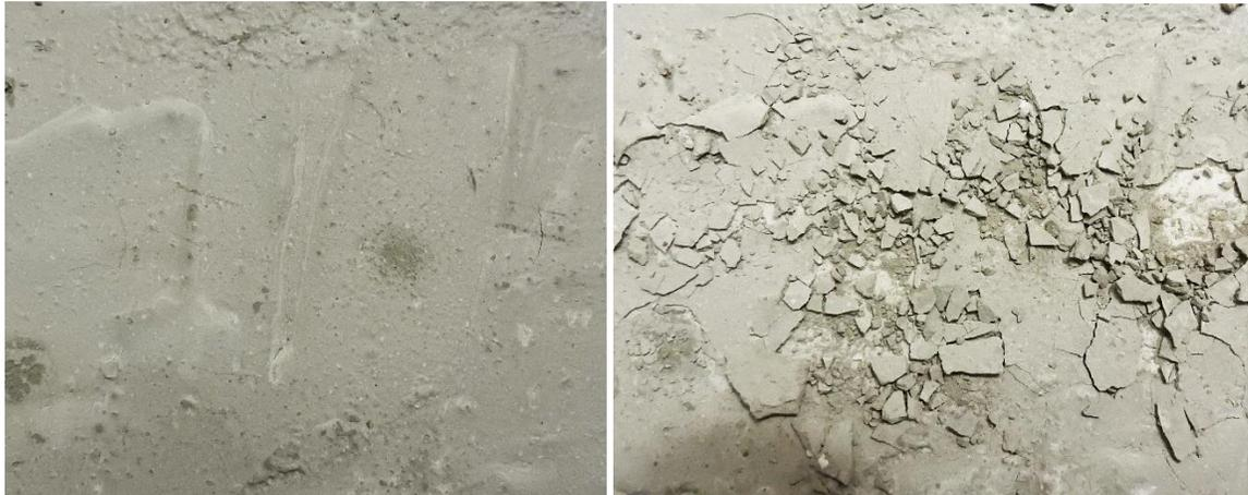
**Figura 39. Prueba 2 y su resistencia al impacto**
