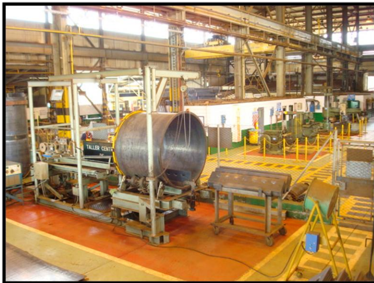
Figura 13. Cosedora de virolas del taller de Casing
