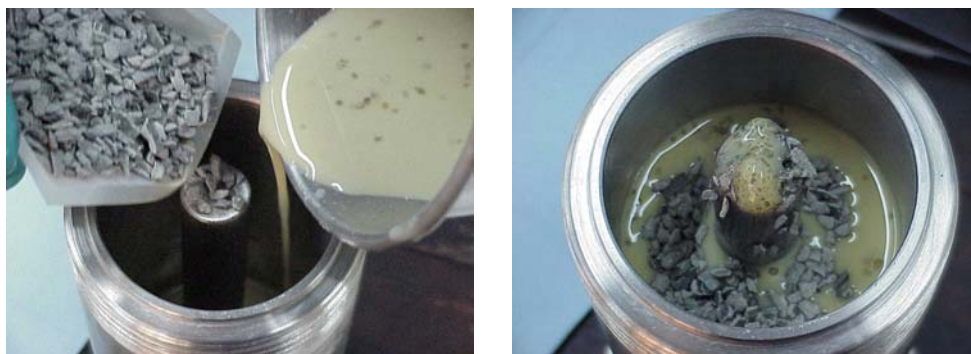
Figura 63. Montaje de la prueba de acreción (Lab. TOP - ICP, 2005)
