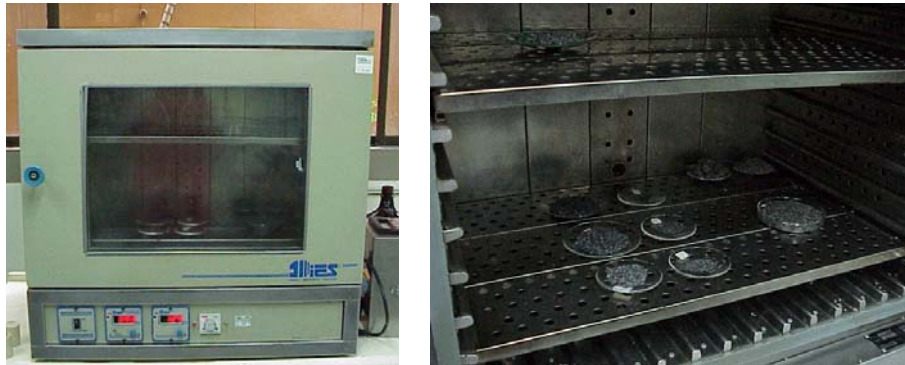
Figura 58. Horno de secado (Lab. TOP - ICP, 2005)
