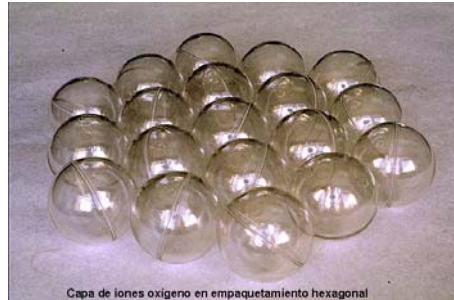
Figura 6. Empaquetamiento hexagonal ( www.edafologia.com )
