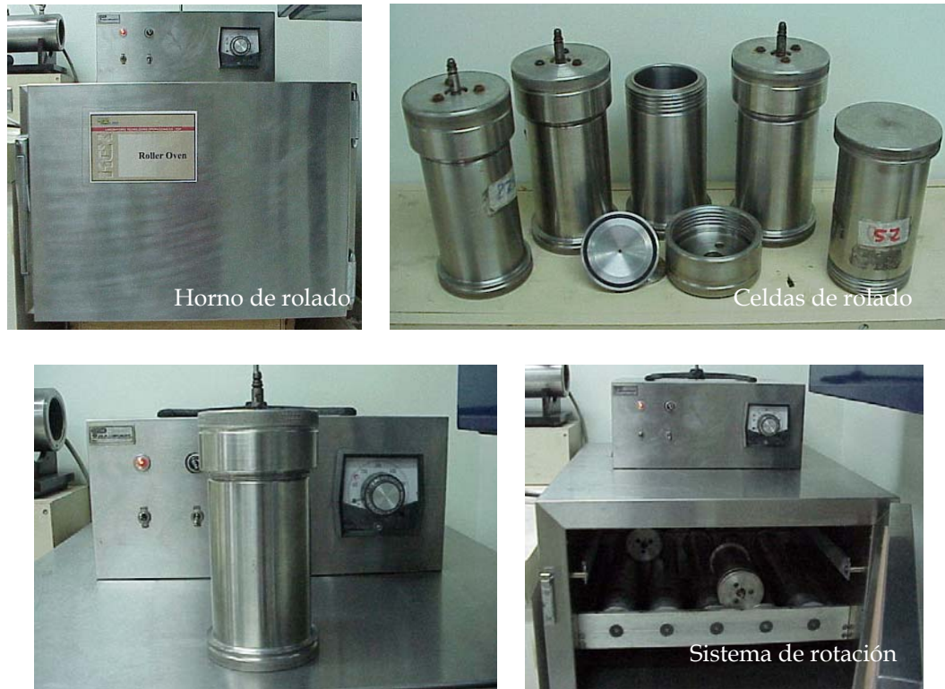
Figura 56. Equipo para envejecimiento por rolado (Lab. TOP - ICP, 2005)
