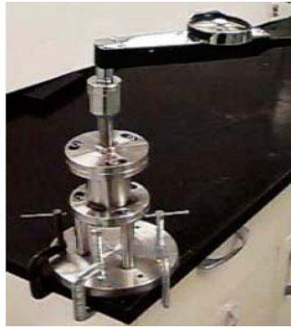
Figura 65. Equipo de valoración de dureza (Patel et al., 2002)
