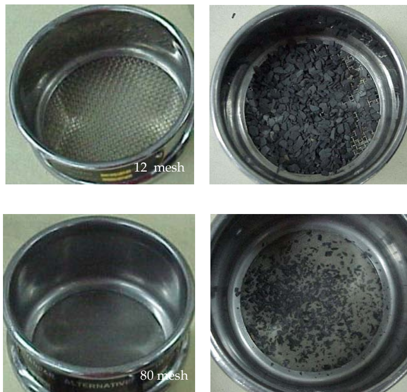
Figura 60. Tamices 12/80 y recortes recuperados (Lab. TOP – ICP, 2005)
