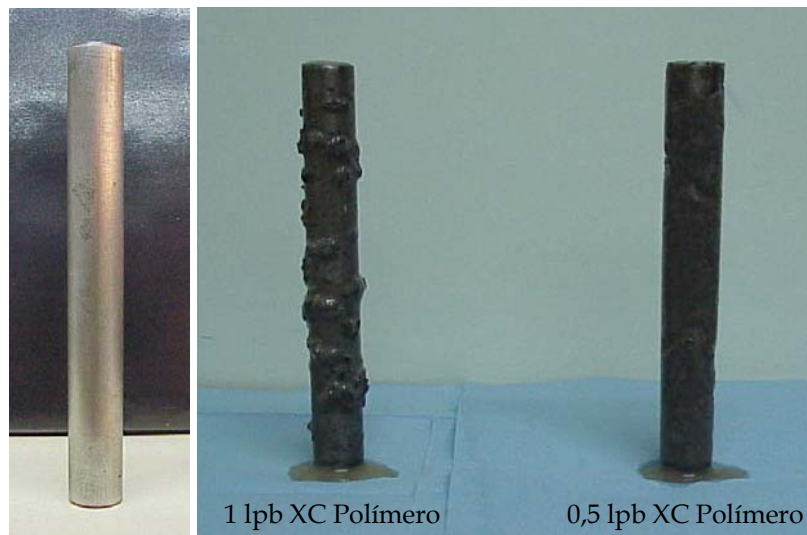
Figura 89. Efecto del polímero sobre la acreción de partículas
