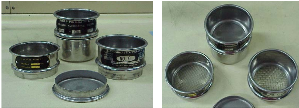
Figura 57. Tamices (Lab. TOP - ICP, 2005)
