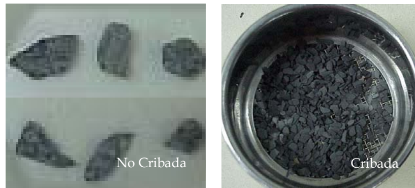
Figura 59. Recortes de lutita (Lab. TOP - ICP, 2005)
