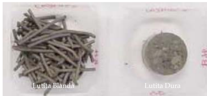
Figura 66. Lutita expuesta a la prueba de dureza (Patel et al., 2001)
