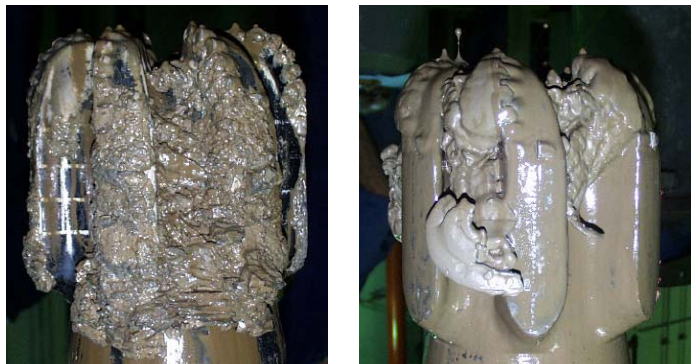
Figura 61. Embolamiento de la broca /bit balling/ (Bland et al., 2001)
