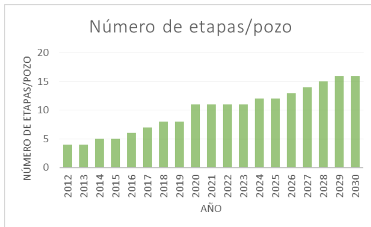
Figura 7. Evolución del número de etapas de fractura por pozo entre los años 2012 a 2030 en el reservorio de Vaca Muerta (argentina).
