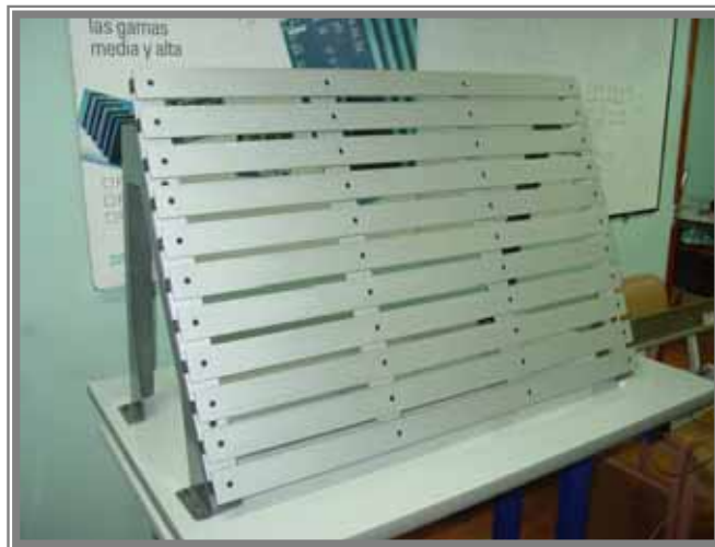
Figura 18. Panel de montaje.
