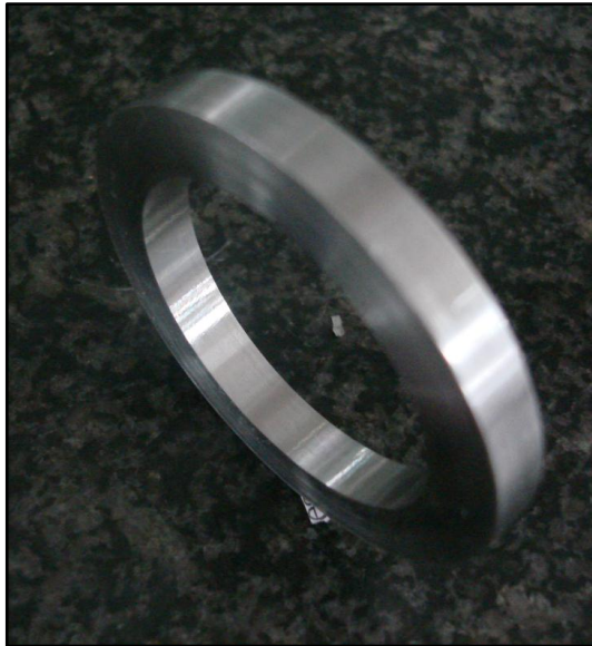
Figura 237. Separador Camisas Terminado
