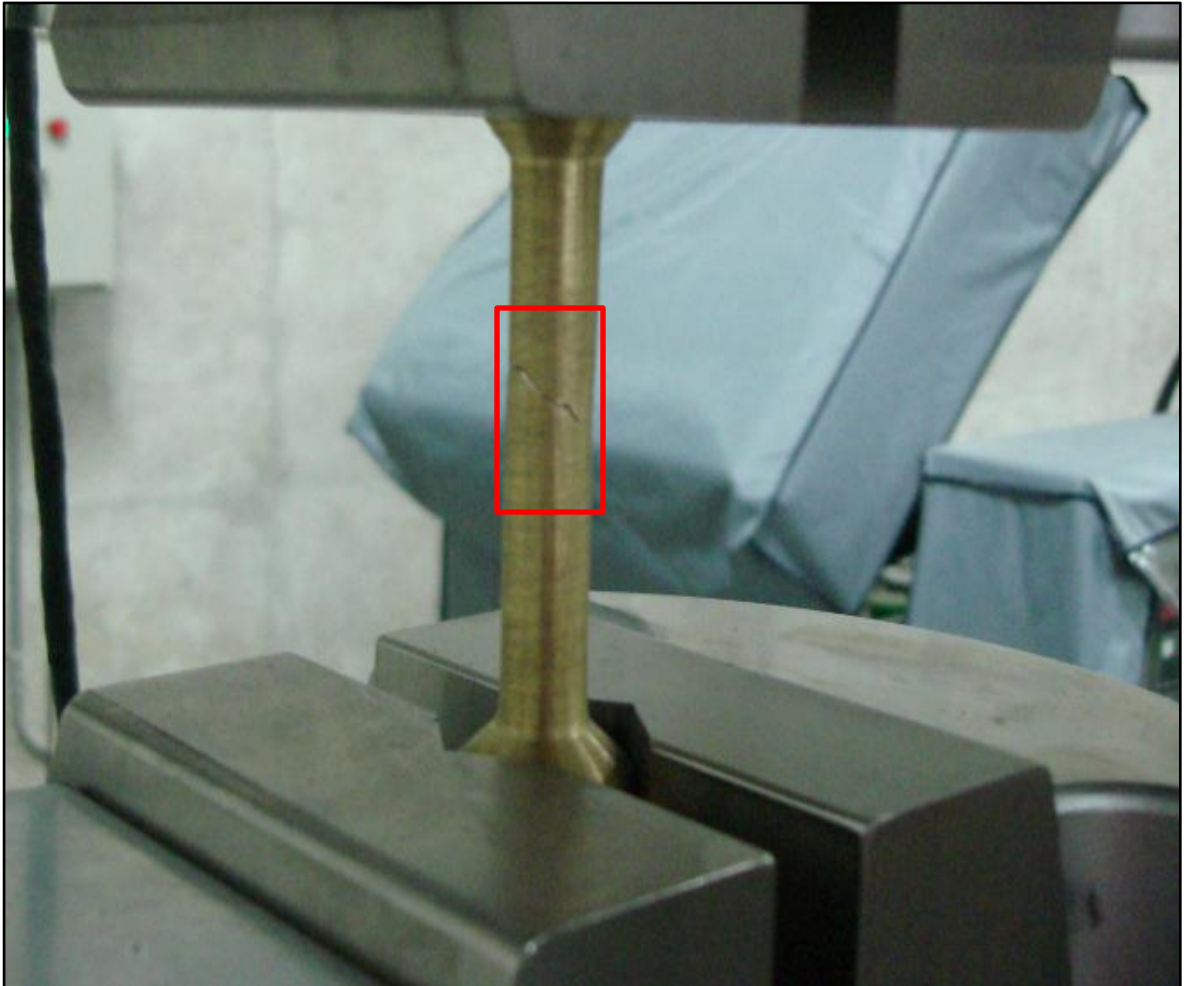
Figura 57. Fractura de la Probeta de Latón
