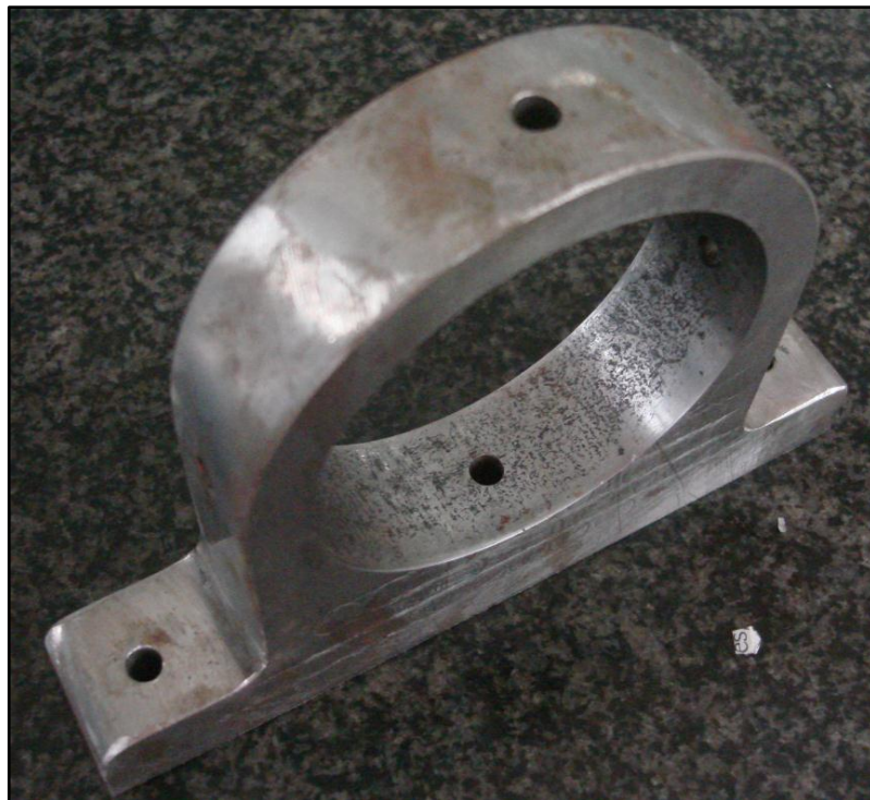
Figura 261. Base Antigiro Terminada
