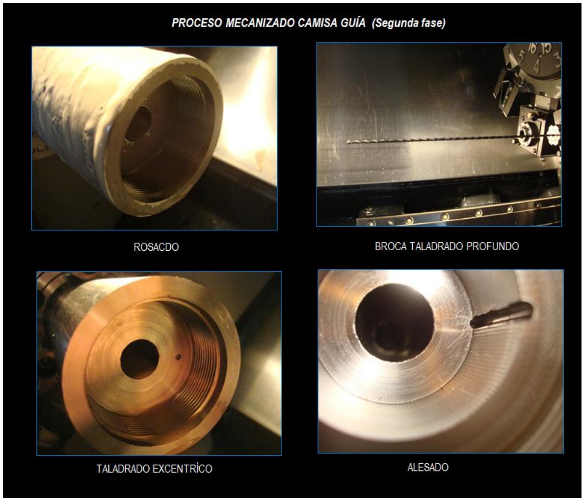
Figura 250. Proceso Mecanizado Camisa Guía (segunda fase)
