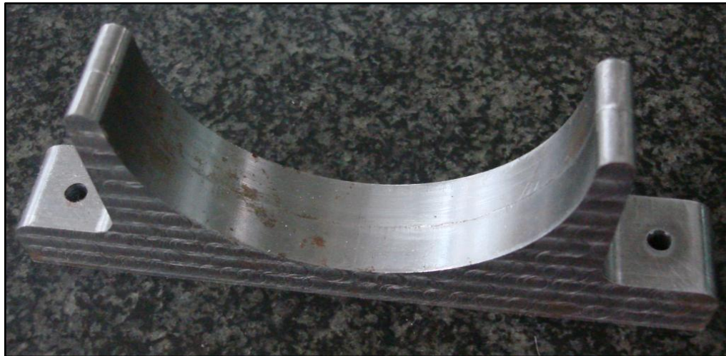
Figura 260. Base Frontal Terminada
