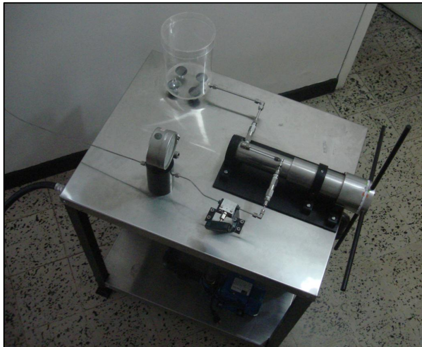
Figura 281. Montaje adecuado para el prototipo de Bomba de desplazamiento positivo
