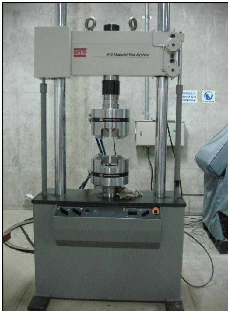
Figura 52. Máquina "MTS 810 Material Test System" para ensayos de tracción
