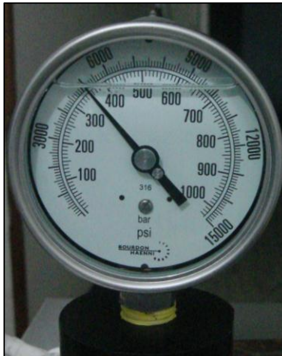
Figura 268. Presión de prueba-bomba 4900 psi
