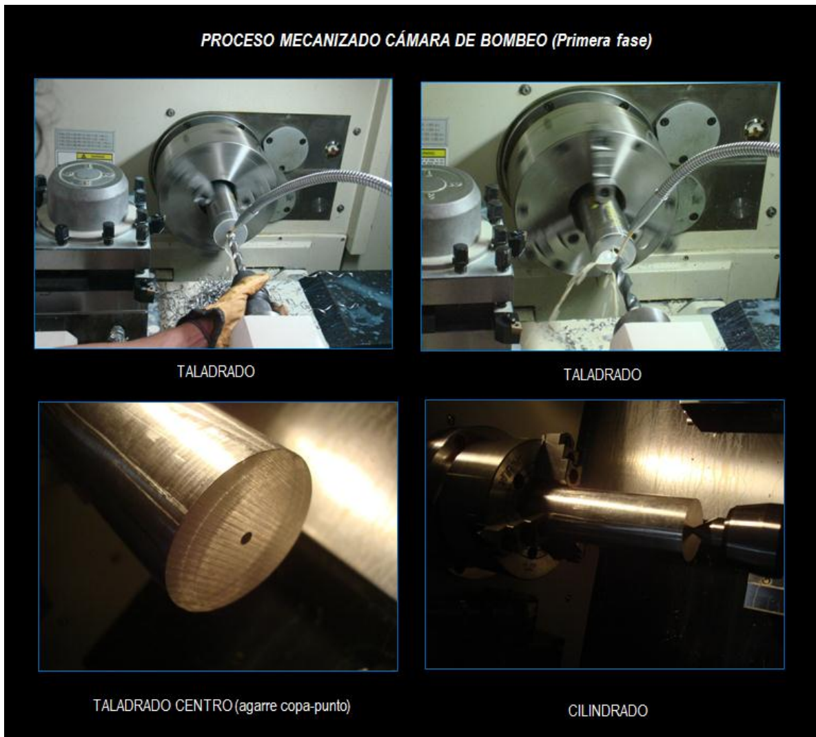
Figura 244. Proceso Mecanizado Cámara de Bombeo (primera fase)
