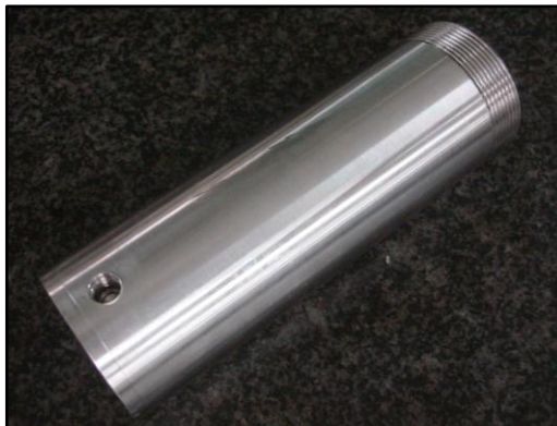
Figura 248. Cámara de Bombeo Terminada
