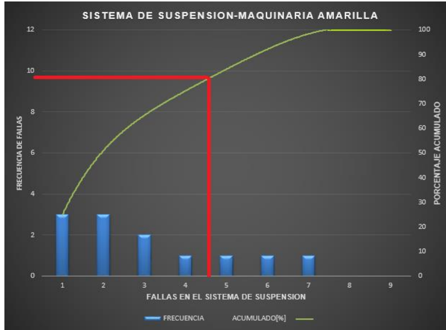
Figura 25.Pareto del sistema de suspensión para vehículos especiales
