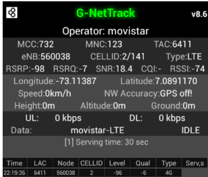
Figura 52. Verificación 2 de conexión a la celda 4G
