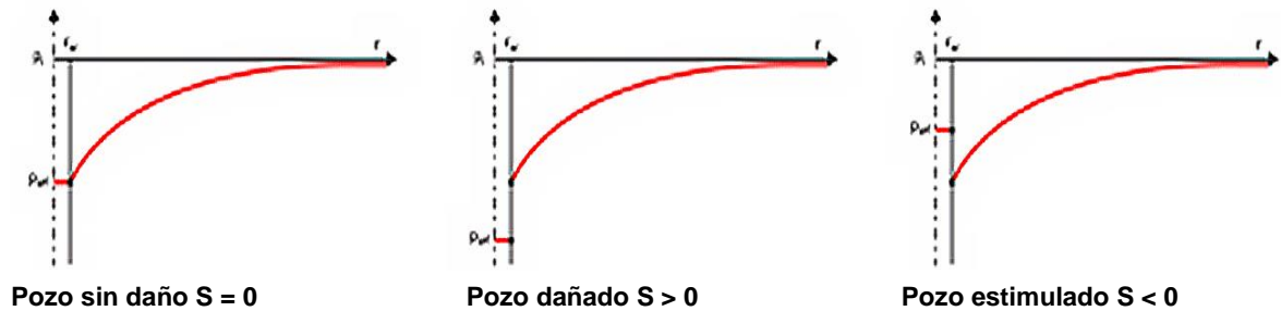
Figura 14. Perfil de presión para un pozo dañado o estimulado
