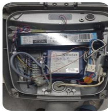
Figura 16 Componentes de una luminaria LED
