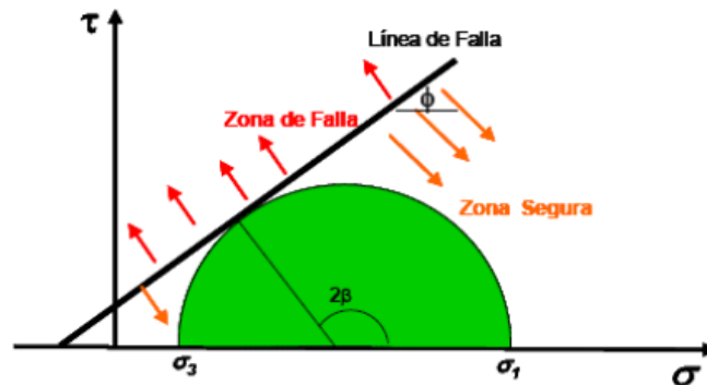
Figura 1.8 Círculo de Mohr para una prueba de compresión triaxial. Fuente: Modificado Seminario “Stress and Strain”, Carl Sondergeld.
