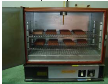
Figura 3.6 estufa para el proceso de secado
