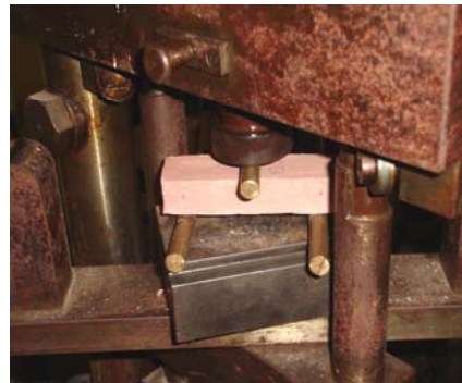
Figura 2.10 Detalle ensayo de flexión
