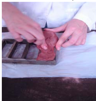
Figura 2.4 Moldeo manual pasta cerámica
