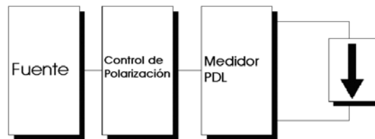
Figura 2.25 Sistema para medidas de PDL de un aislador
