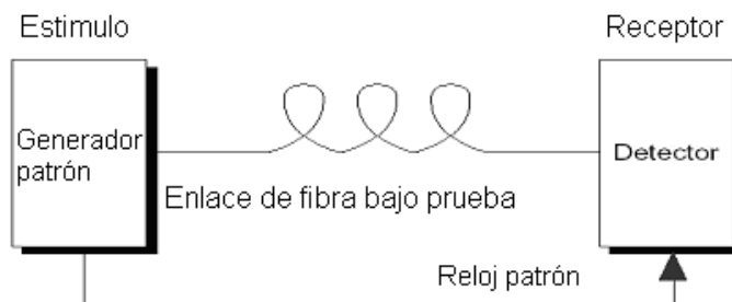
Figura 3.02 Sistema BER usando un generador patrón tradicional.
