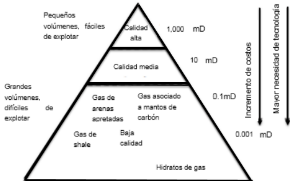
Figura 2. Triángulo de recurso para el gas natural
