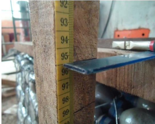
Figura 27. Regleta para medir deformación (se tomó 96 cm como punto de referencia)
