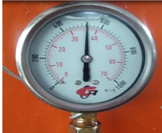
Figura 25. Presión máxima (36 bar) a la cual se volcó el gavión relleno de botellas PET.
