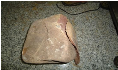
Figura 3. Fractura de una roca ensayada a compresión.
