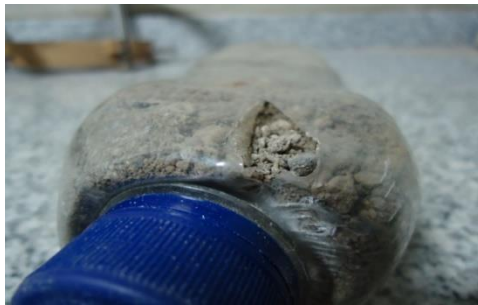
Figura 2. Rompimiento de una botella PET que se ensayó con C. Transversal
