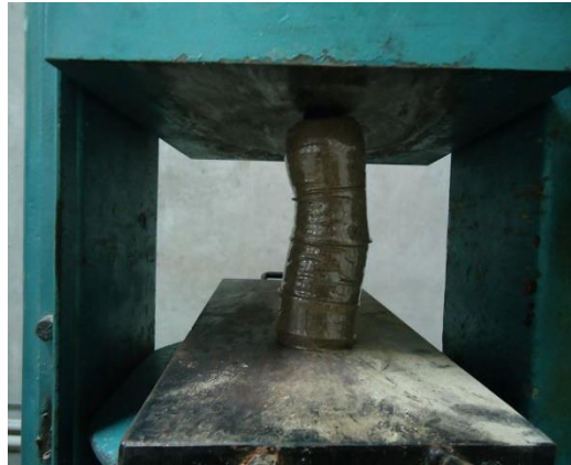
Figura 4. Ensayo de Botella PET, sometida a carga axial.
