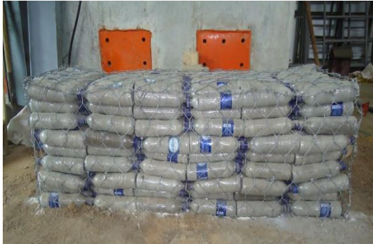
Figura 13. Vista frontal del gavión con botellas PET
