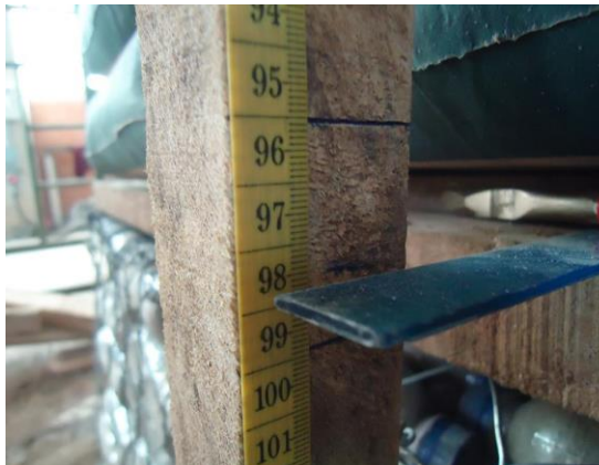
Figura 28. Deformación vertical de la unidad de gavión de botellas PET, aprox. 2.8 cm.
