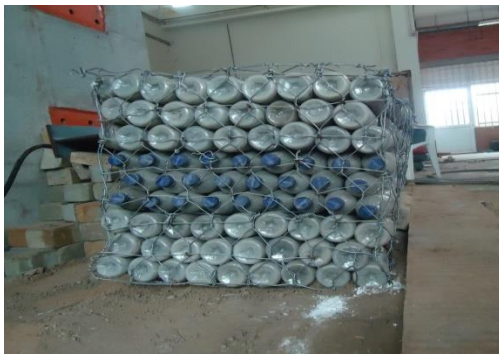
Figura 15. Volcamiento del gavión con botellas PET
