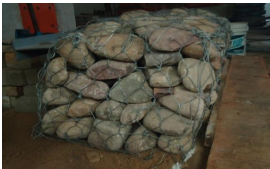
Figura 9. Volcamiento del gavión tradicional
