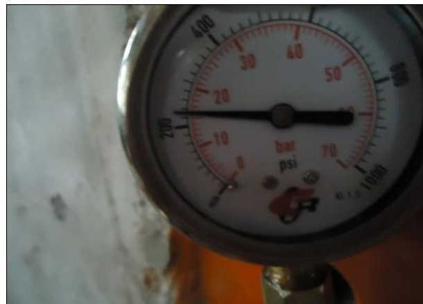
Figura 21. Presión máxima (16 bar) a la cual se desplazó el gavión relleno de botellas PET.
