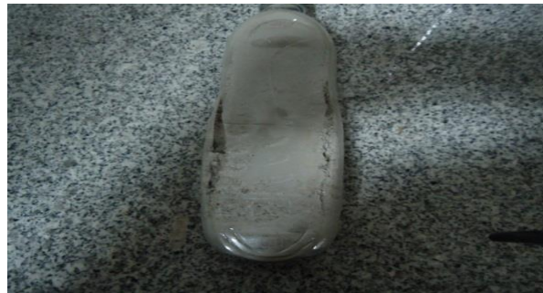
Figura 5. Fisuras de una botella PET sometida a carga transversal
