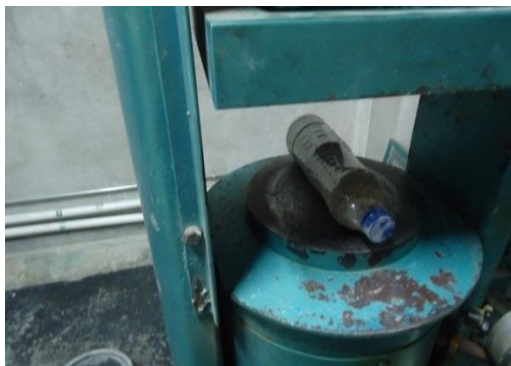
Figura 3. Ensayo de Botella PET, sometida a carga transversal.
