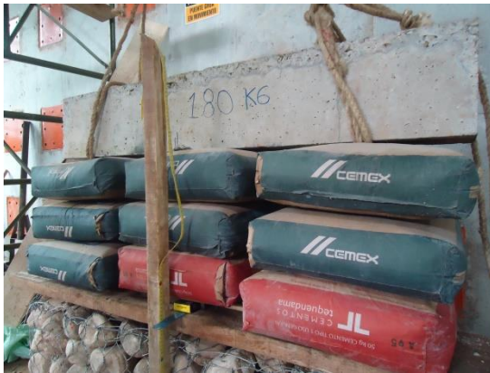
Figura 7. Carga vertical del Gavión tradicional
