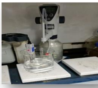
Figura 20. pHmetro, dosificador de reactivos y solución diluida sobre plancha magnética
