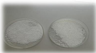
Figura 23. Muestra de polímero después de secado por una hora en horno a 105^\circ\text{C}
