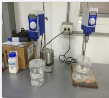
Figura 17. Proceso de hidratación de la solución polimérica con agitadores mecánicos
