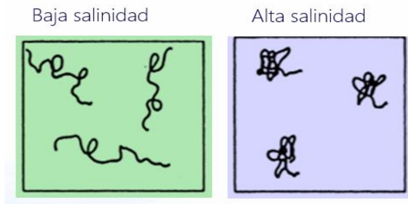
Figura 5. Esquema del efecto de las fuerzas iónicas en la conformación de poli electrolitos flexibles como HPAM. Adaptado de Sorbie, K. S. (1991). Polymer-improved oil recovery. Springer Science & Business Media.
