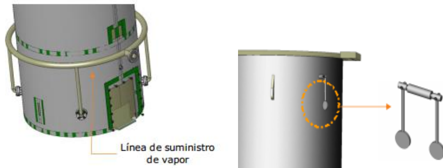
Figura 39. Distribución de vapor y control de nivel de fruto
