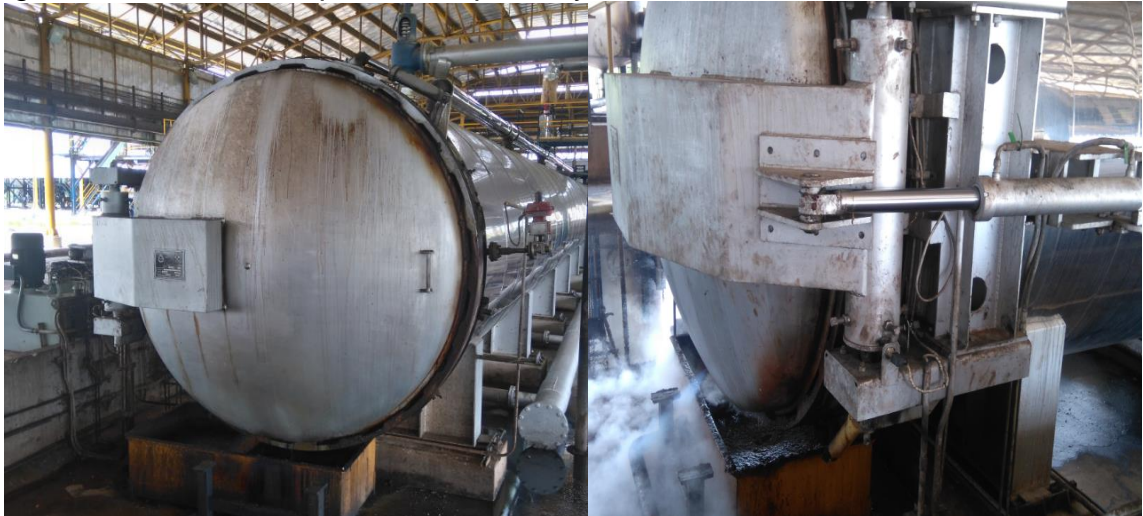
Figura 28. Cilindro de apertura de puerta y cilindro de la cremallera
