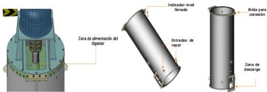
Figura 38. Cilindro y zona de carga del digestor
