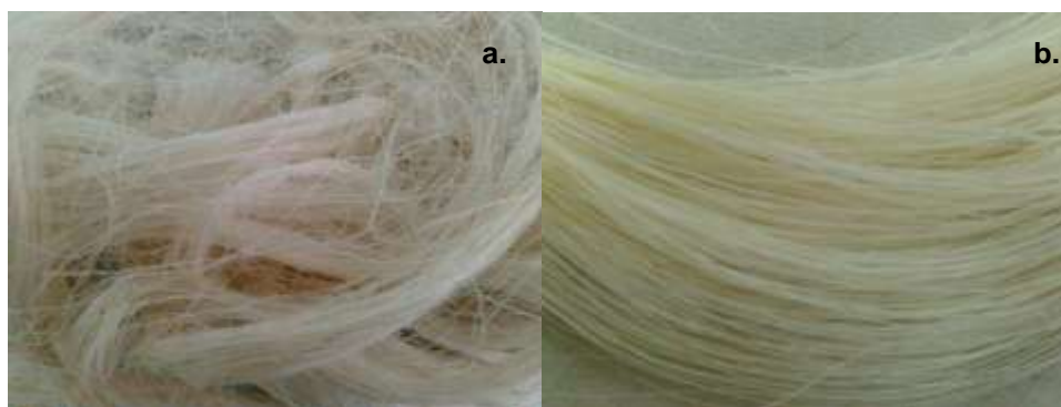
Figura 11. a) Fibras de Fique suministradas por ASEDEFIQUE; b) Fibras de Fique limpias.
