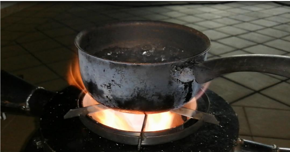
Ilustración 23. Operación el equipo sin aire primario en exceso.
