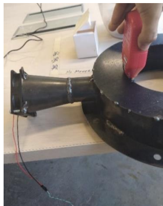
Ilustración 19. Medición de flujo de aire secundario.
