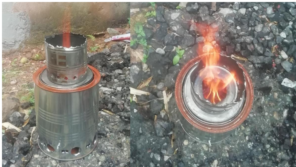
Ilustración 16. Pruebas de tiro natural con altura de lecho de 12,5 cm.
