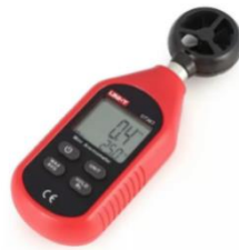
Ilustración 18. Anemómetro portátil Uni-T UT363.
