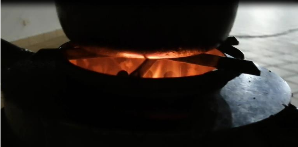
Ilustración 22. Operación del equipo con exceso de aire primario.
