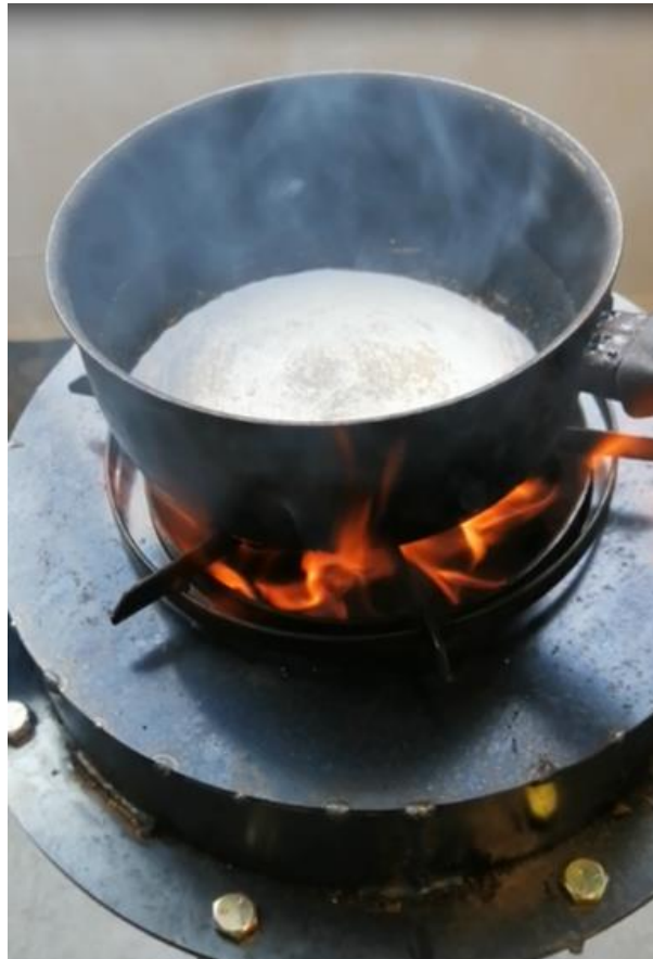
Ilustración 24. Operación del equipo con baja relación AS/AP.
