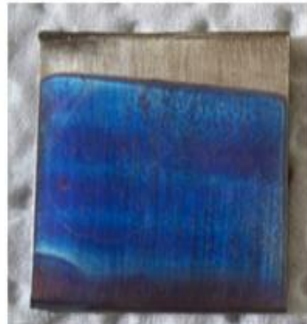
Películas N-TiO 2 preparadas con etóxido de titanio (IV). Relación molar alcóxido: en (1/3:1).
