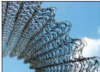
Figura 26. Mallas de alambre entretejido y de fibra de vidrio.
