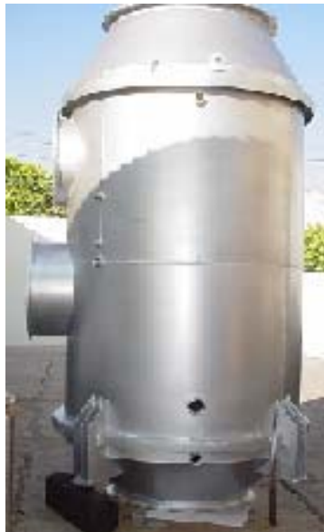
Figura 32. Lavadores de Gases.
