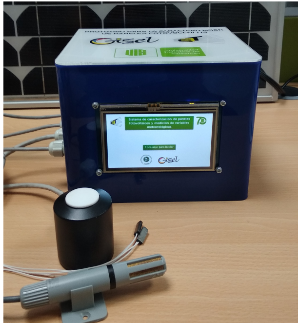
Figura 5.2: Prototipo de caracterización de paneles fotovoltaicos y de medición de variables meteorológicas.
