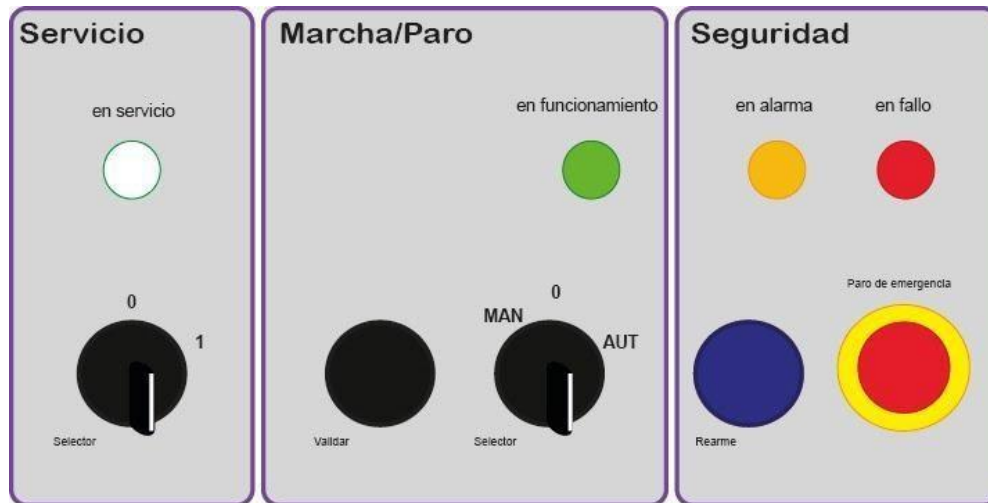
Figura 15. Panel industrial para la intervención del operario mediante el uso de la guía GEMMA.
