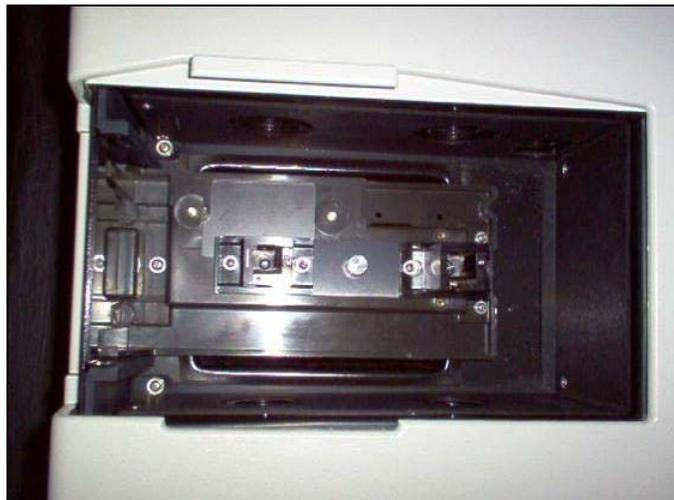
Figura 13. Medición de reflectancia.
