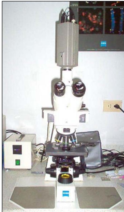
La fuente de luz se basa en una lámpara de arco de mercurio, integrada con un reflector parabólico el cual permite que los haces de salida vayan a la corredera de reflectores, en donde se encuentran el reflector encargado de dirigirla luz hacia la muestra, donde se tiene el filtro que bloquea la luz ultravioleta (UV) para cuando esta se envíe hacia la cámara.
