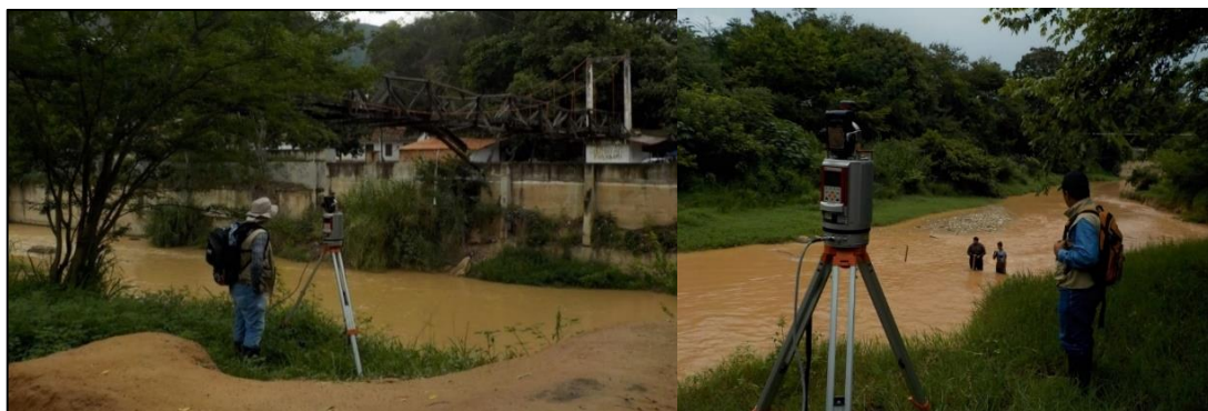
Figura 36. Levantamientos en campo con TLS. Nota. Tomado de: Equipo técnico UIS
