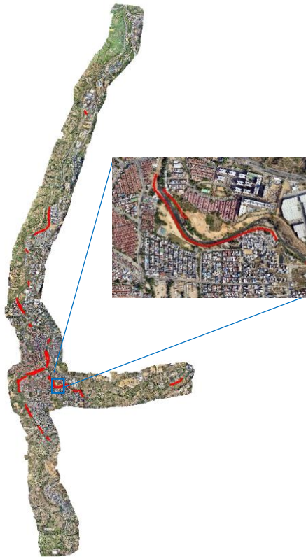
Figura 11. Localización de muros a partir de las imágenes UAV y nube de puntos TLS.
