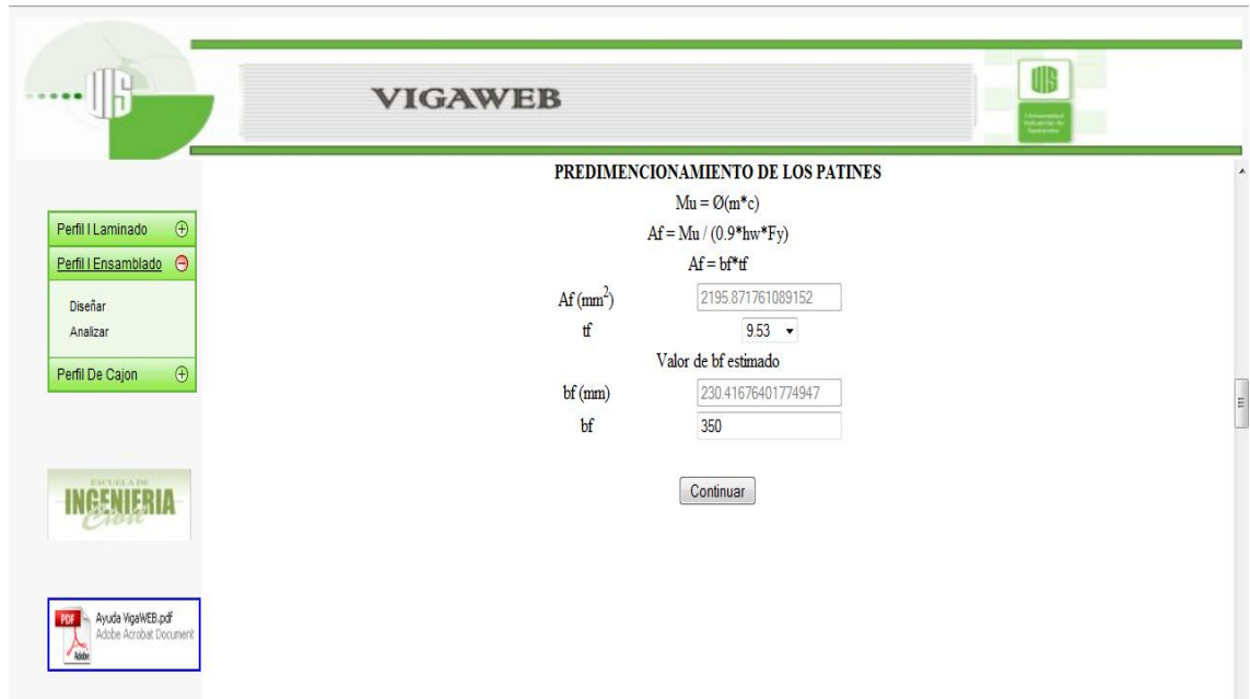
Figura 74. Selección del t_f y del b_f , diseño Viga I ensamblada.
