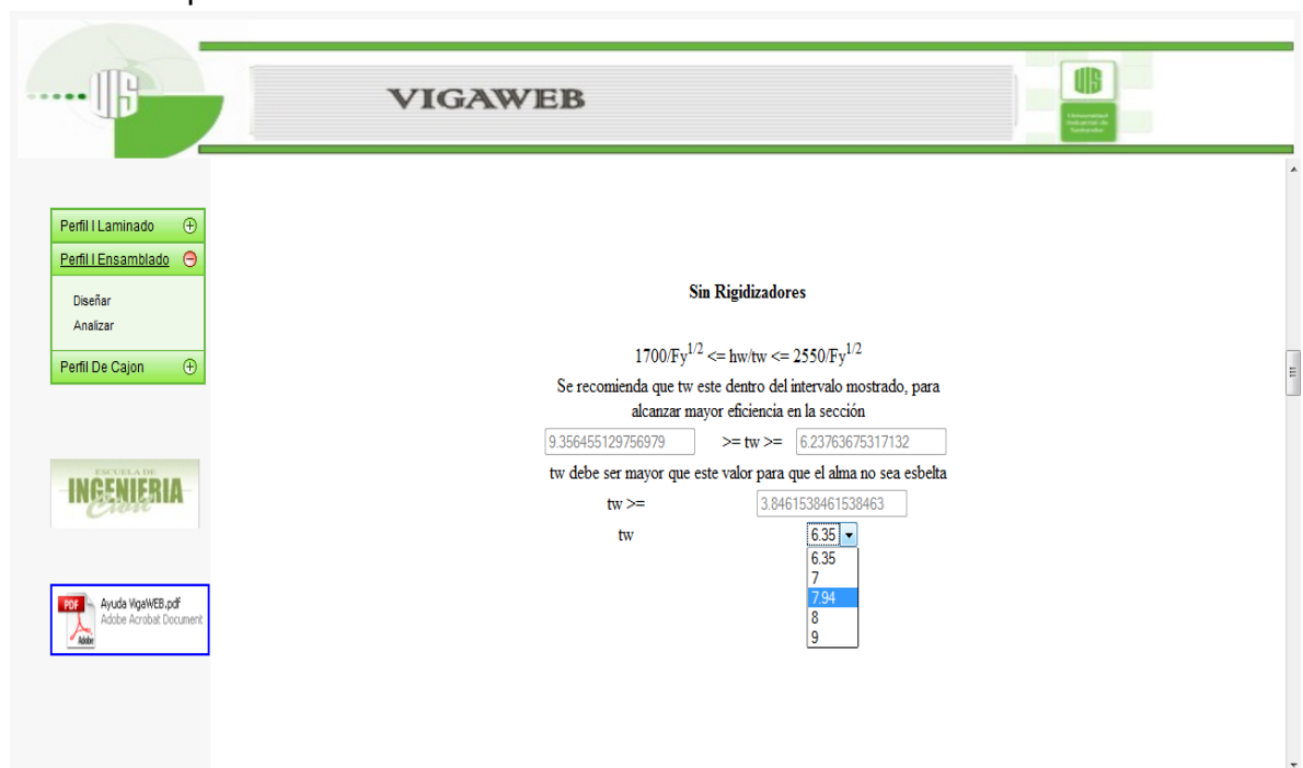
Figura 73. Selección del t_w , diseño Viga I ensamblada.
