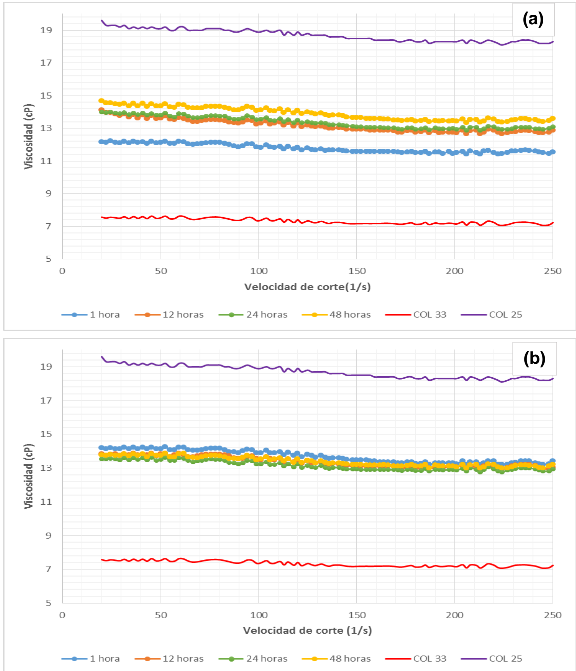
Figura 8. Variación de la viscosidad a T_1=40^\circ\text{C} a diferentes tiempos para la mezcla de crudos: a) con asfaltenos agregados y dispersos; b) con asfaltenos dispersos.
