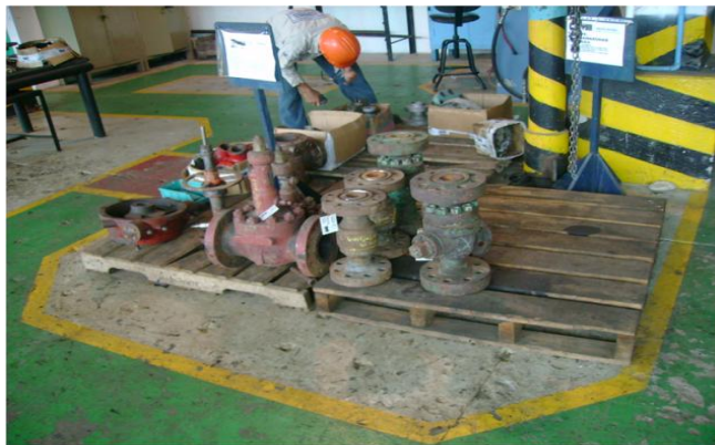
Figura 10. Control visual de válvulas
