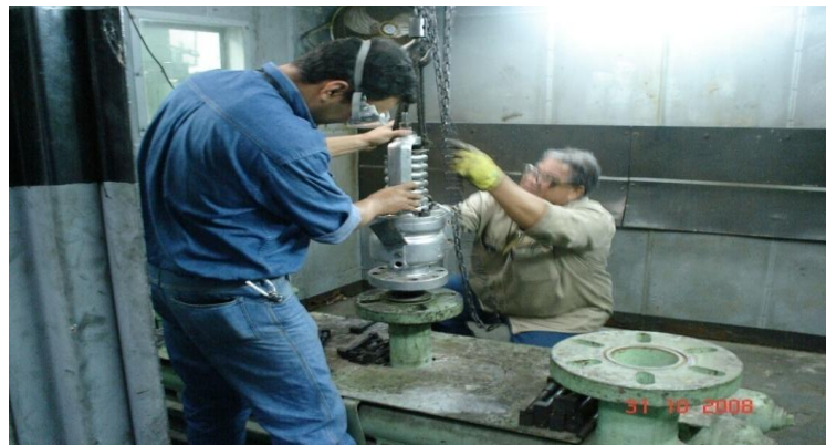
Figura 15. Banco de prueba y calibración de válvulas de seguridad
