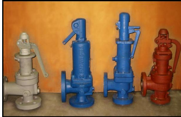
Figura 7. Fotografía de válvulas de seguridad
