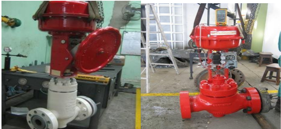
Figura 16. Banco de prueba y calibración de válvulas de control
