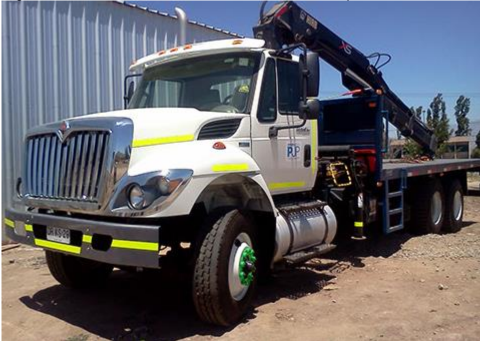
Figura 2. Grúa international montada en camión plataforma.
