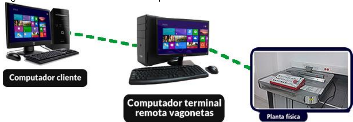
Figura 64. Conexión cliente-servidor-planta física.
