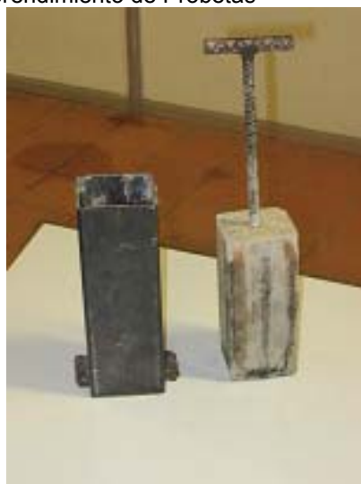
Fotografía E3. Ensayo de desprendimiento de Probetas
