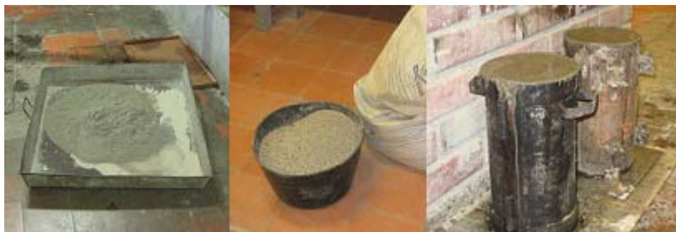
Fotografía E1. Preparación de Cilindros
