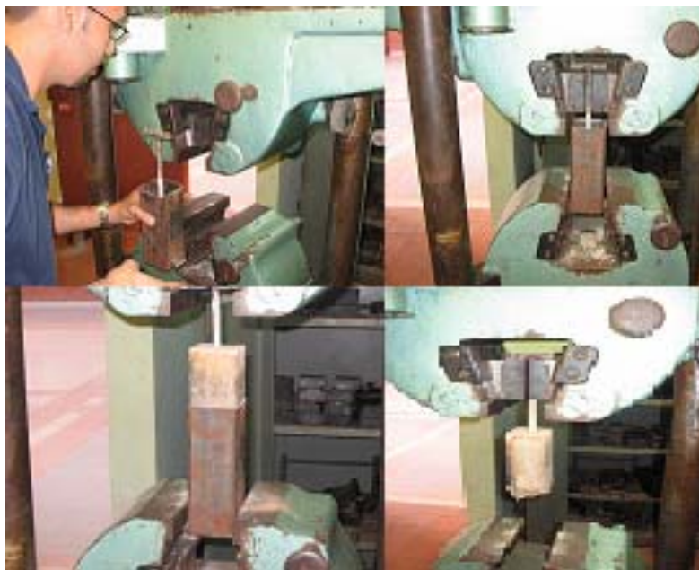
Fotografía 5. Ensayo de Desprendimiento del Mortero
