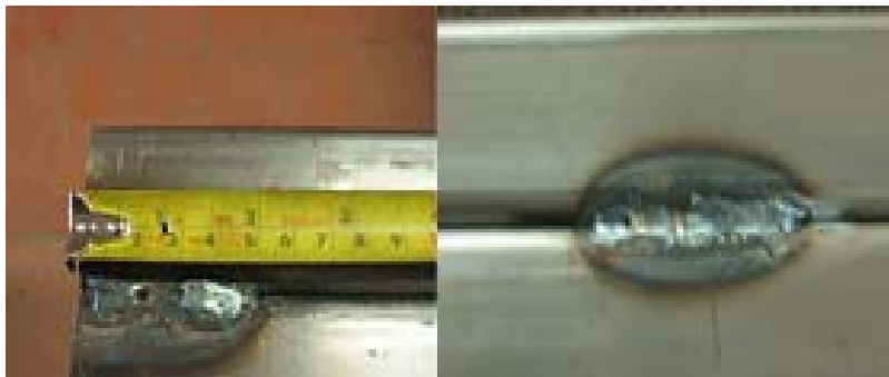
Fotografía 6. Cordón de Soldadura
