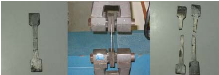
Fotografía H1 Ensayo de Tracción para Acero Grado 40
