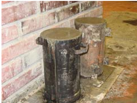
Fotografía 3. Probetas de Mortero de Pega para ensayos de Compresión
