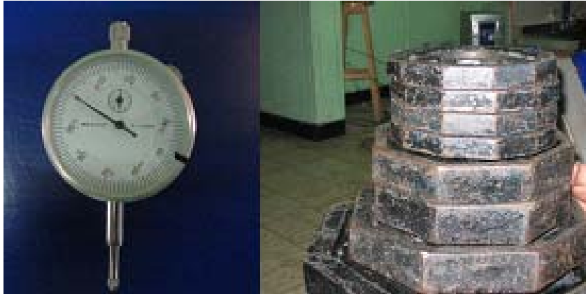
Fotografía 14. Deformímetro y Discos de Hierro
