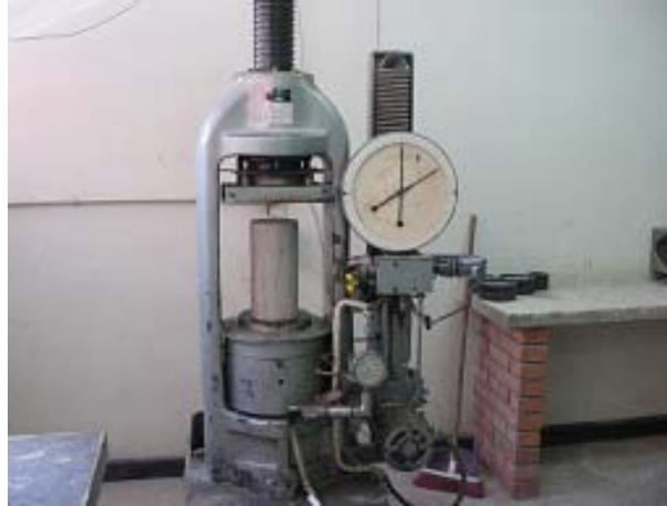
Fotografía E2. Ensayo a Compresión de Los Cilindros
