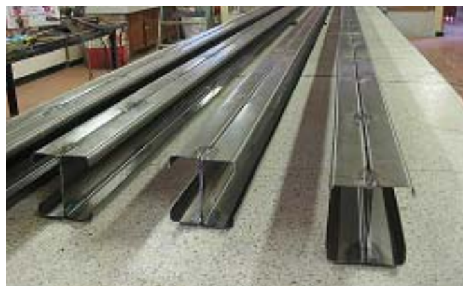
Fotografía 9. Vigas armadas en I
