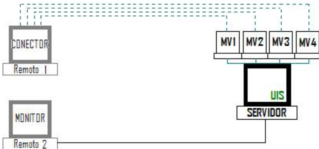
Figura 103. Prueba Remota, conexiones una a una
