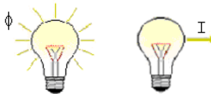
Figura 3. Comparación entre el flujo luminoso y la intensidad luminosa.
