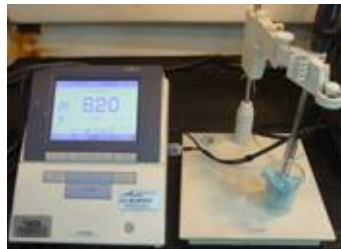
Figura J.3. Potenciómetro Marca HORIBA, utilizado en la medición de pH antes de la reticulación en fluidos base agua
