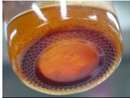
Figura S2: Precipitado formado en fluido base aceite propuesto sin agente gelificador después de 12 horas de calentamiento a BHST
