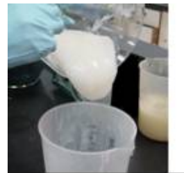
Figura J.4. Formación de la lengua del fluido base agua vivo
