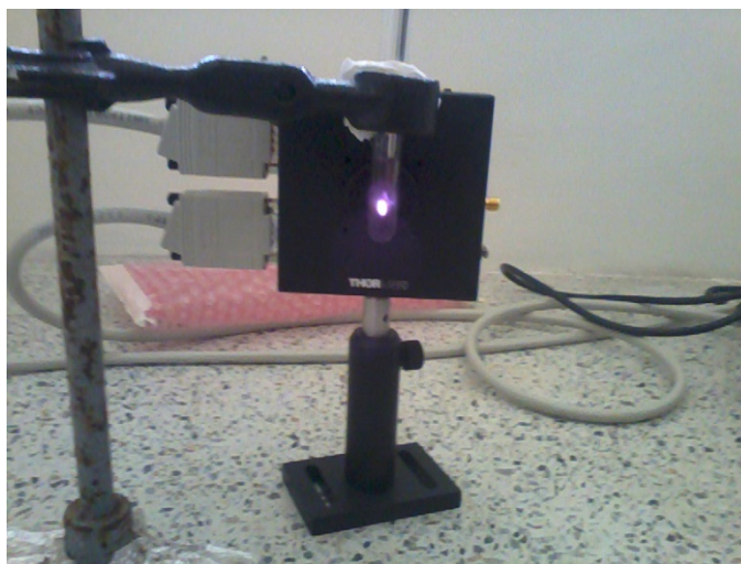
Figura 58. Dispositivo de calentamiento de dispersiones NTC-AF por medio de un diodo laser de 808 nm.
