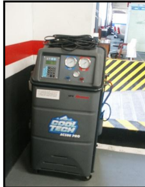
Figura 12. Equipo de recirculación de aire acondicionado
