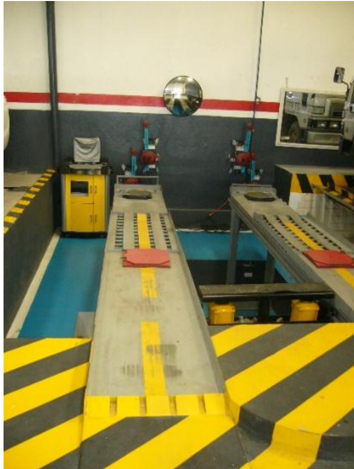
Figura 8. Moderno equipo de alineación tecnología laser
