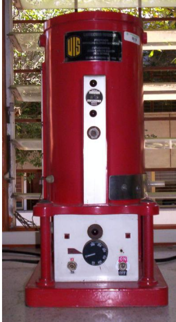
Figura 1. Dispositivo para determinar la humedad con una lámpara infrarroja
