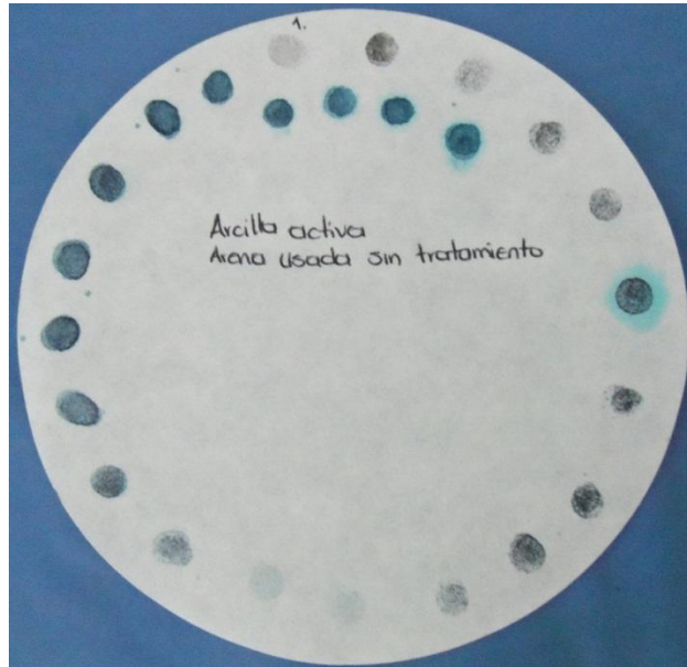
Figura 6. Ensayo azul de metileno para determinar arcilla activa en mezcla de arena usada
