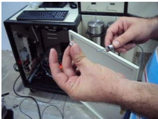
Figura A3. Revisión de las conexiones de las líneas de flujo de la bomba.
