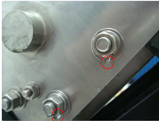
Figura 28. Fuga en las tuercas de la tapa del modelo.
