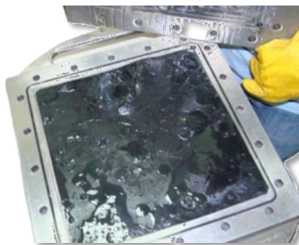
Figura 31. Canalización de fluido entre el empaque y la tapa del modelo.
