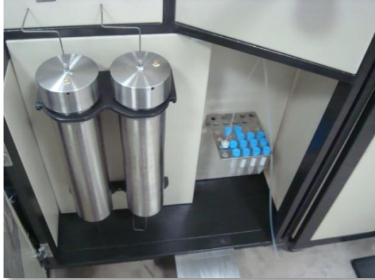
Figura 8. Cilindros para el almacenamiento de agua y de aceite.
