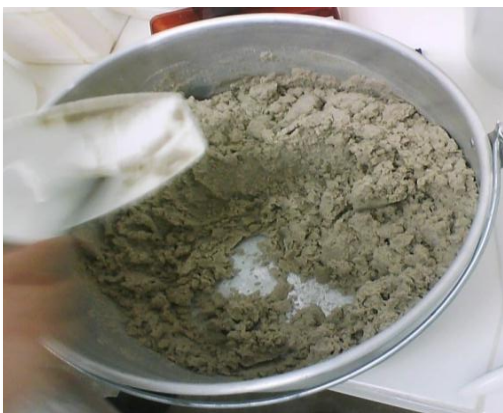
Figura 18. Color uniforme en la mezcla de arena y solución epoxi
