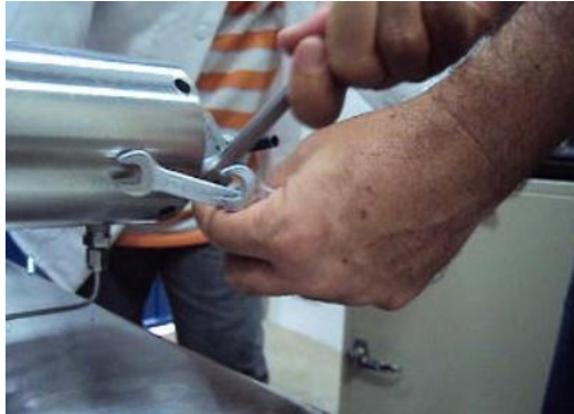
Figura A4. Ajuste de las conexiones de las líneas de flujo de la bomba.
