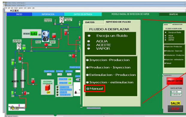
Figura B11. Interfaz de control – Operación manual de las electroválvulas.
