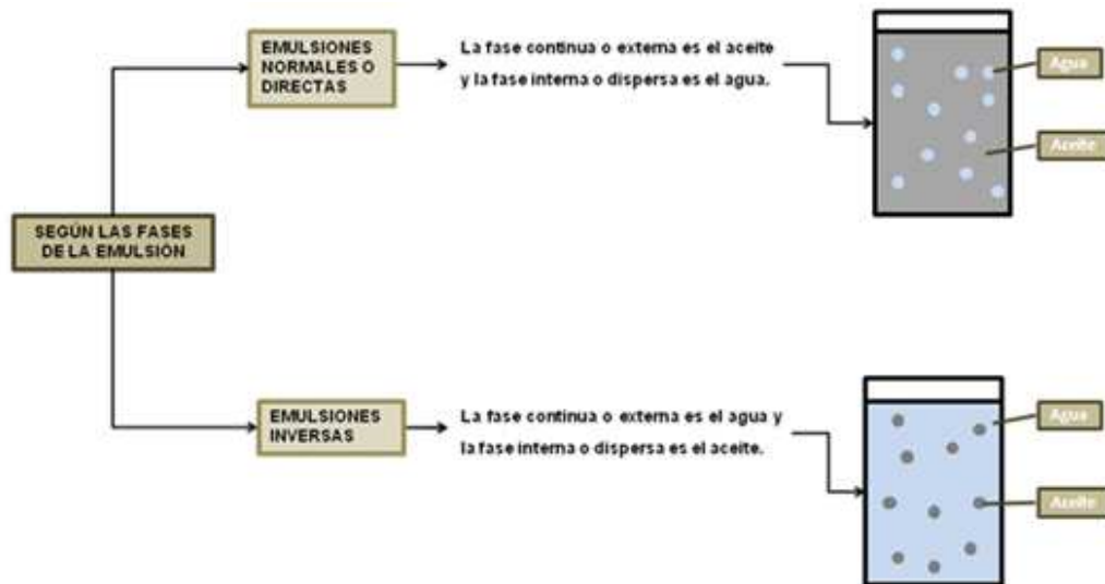
Figura 15. Clasificación según la fase de la emulsión
