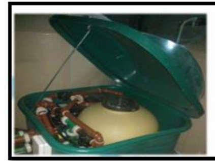
Sistema de filtración
