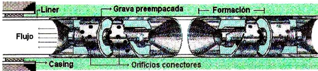
Figura 28. Esquema de un empaquetamiento para un pozo horizontal hueco abierto mediante la utilización de liner o mallas pre-empacado
