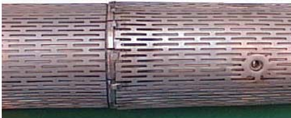
Figura 31. Fotografía del ESS antes de de expansión
