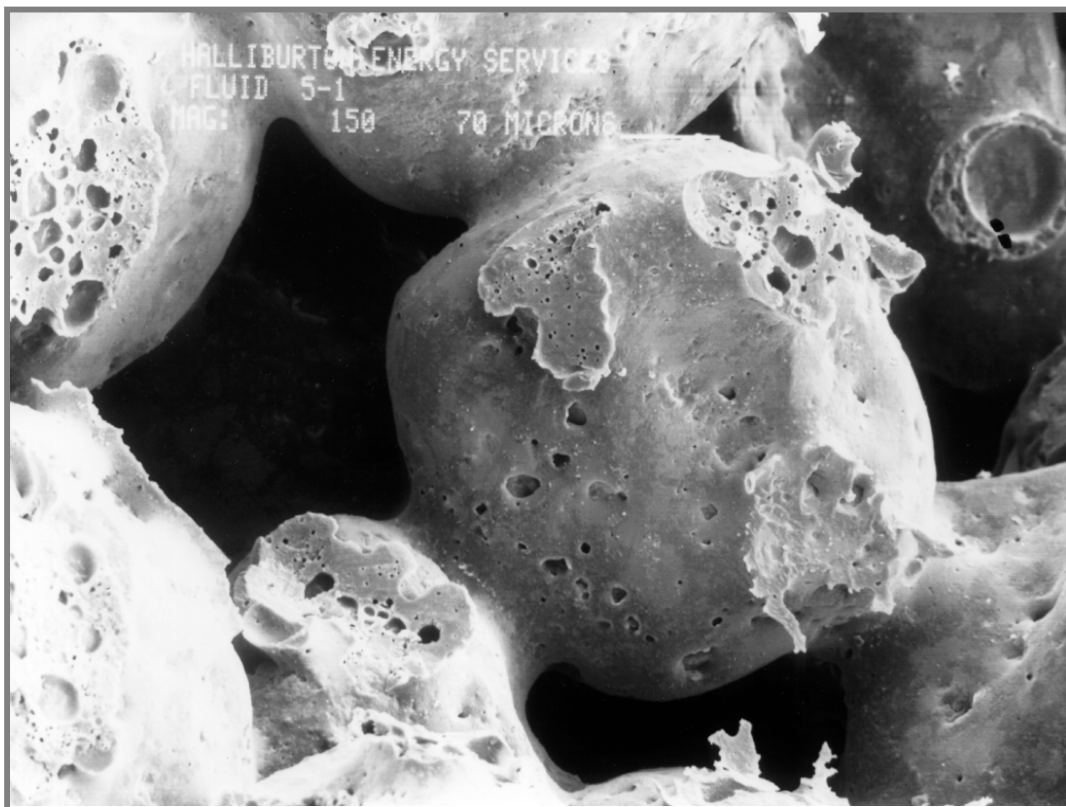
Fig. 21 Efecto de consolidación de los granos
