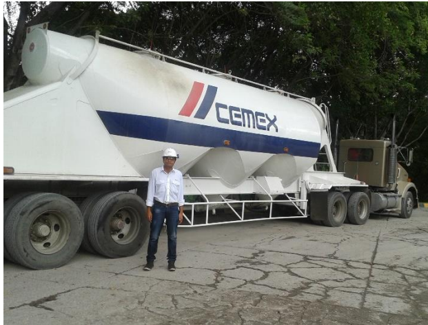
Figura 9. Cisterna transportadora de cemento a granel.
