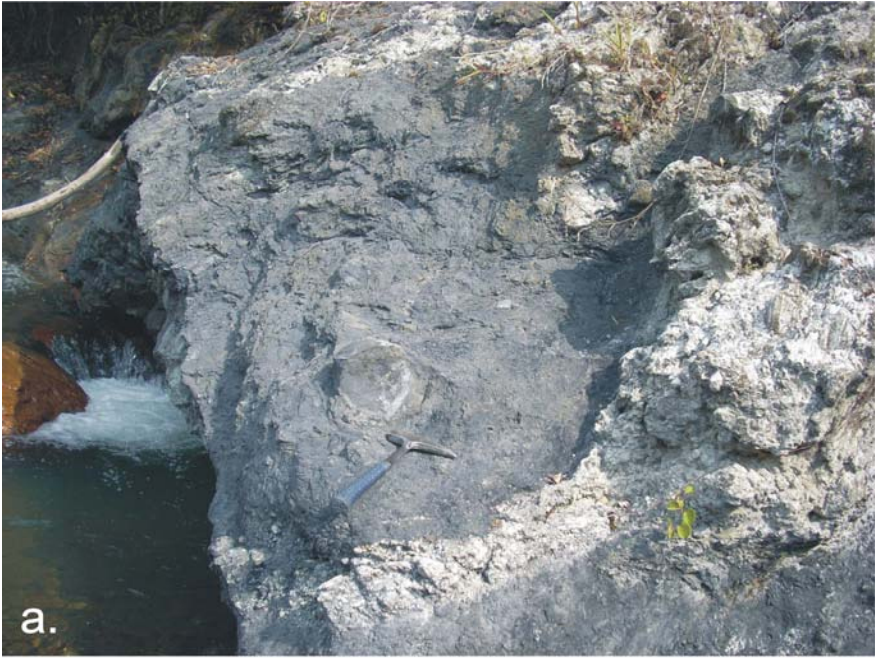
Figura 14. a y b: Aspecto de la litología perteneciente a la Zona I, compuesta fundamentalmente de lodolitas calcáreas de color negra a gris oscura.
