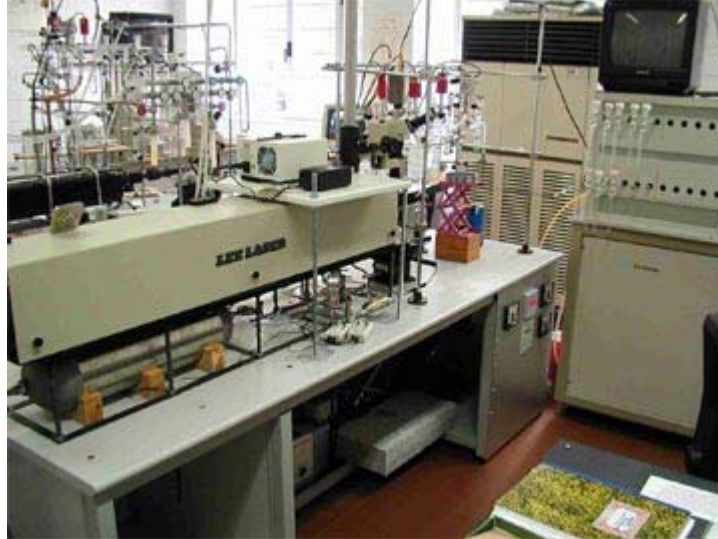
Figura 5. Láser para Análisis de Sulfuros. Área de Espectrómetros del Servicio General de Isótopos Estables, Universidad de Salamanca.
