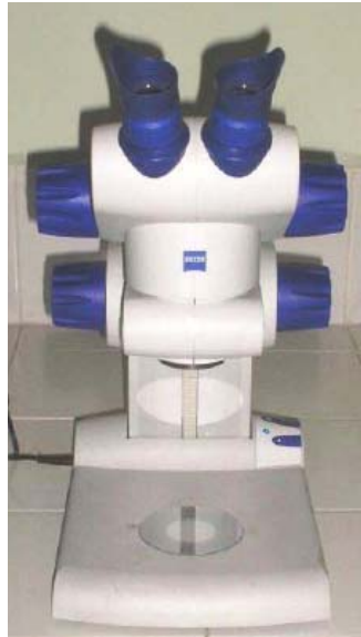
Figura 1. Aspecto de la lupa estereoscópica Stemi DV4 , Carl Zeiss Jena . Laboratorio de Arcillas, Escuela de Geología. Universidad Industrial de Santander (UIS)
