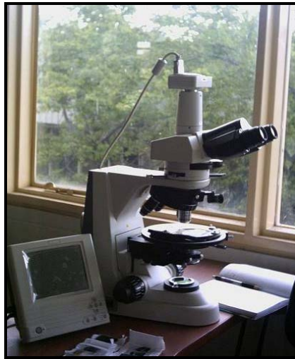
Figura 2. Microscopio de luz transmitida Nikon Eclipse-50i con cámara fotográfica DS-L1. Laboratorio de Microscopía Óptica. Escuela de Geología. Universidad Industrial de Santander (UIS)
