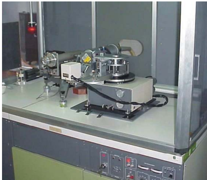
Figura 3. Aspecto del difractómetro utilizado en el presente estudio, marca RIGAKU modelo D/MAX IIIB . Laboratorio de Difracción de Rayos X. Escuela de Química, Universidad Industrial de Santander (UIS).
