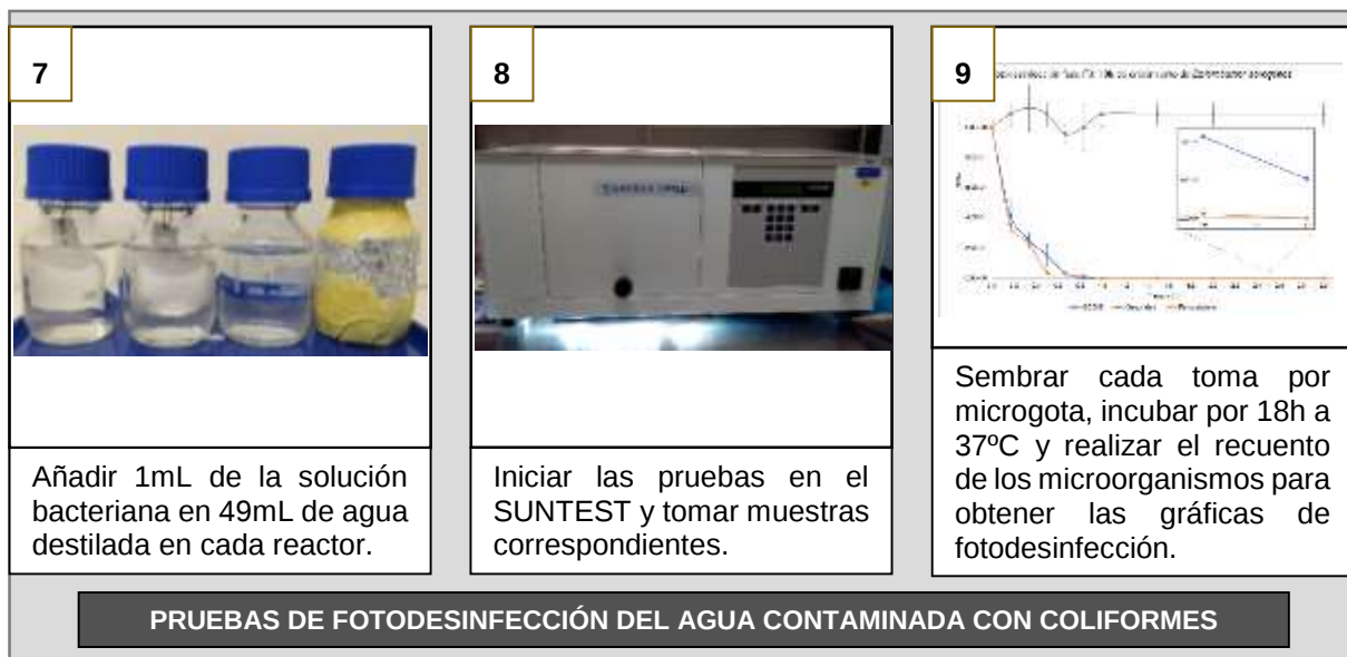
Figura 16. Procedimiento para llevar a cabo las pruebas de desinfección del agua contaminada con coliformes.
