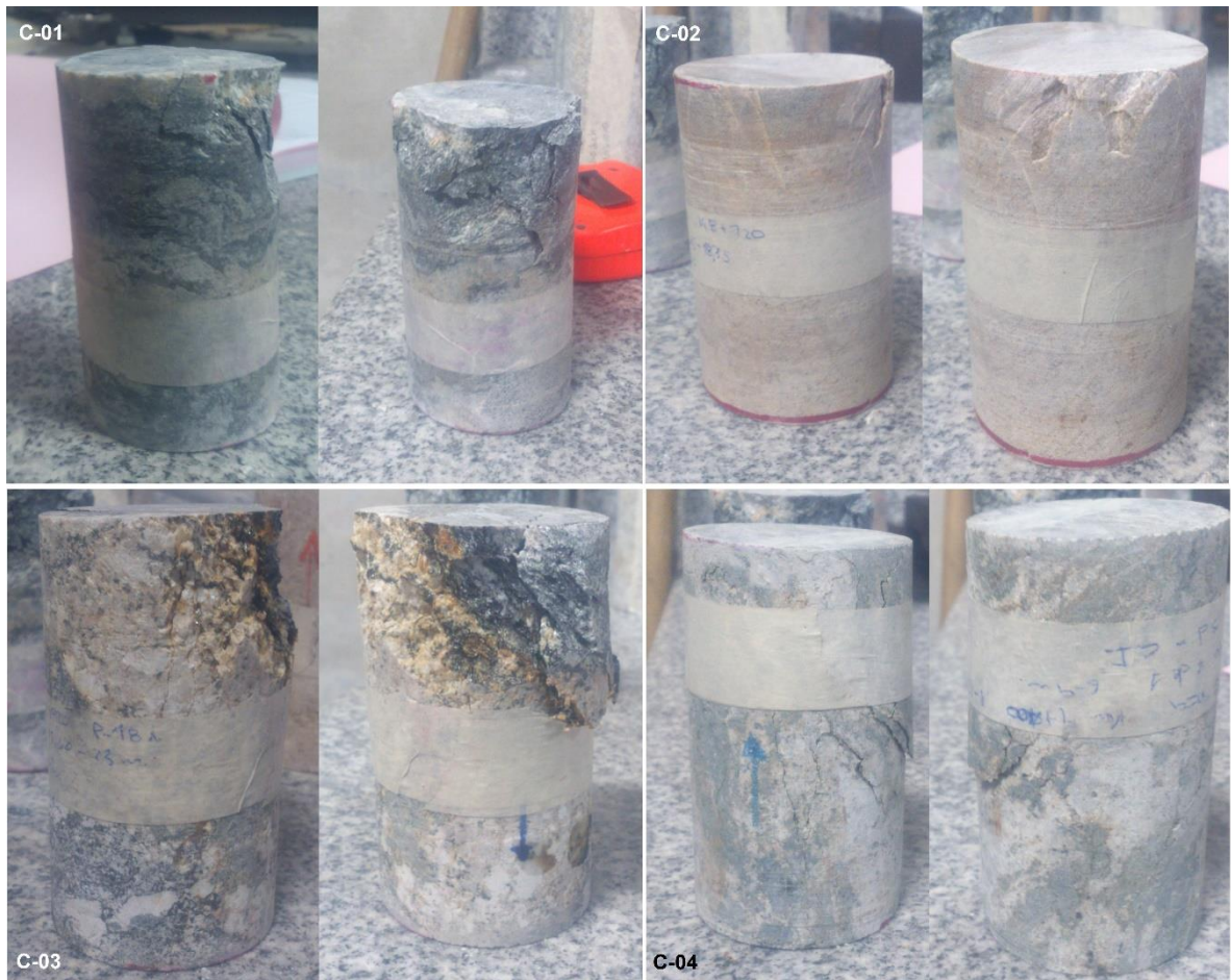
Figura 22. Núcleos fallados tras la compresión simple.
