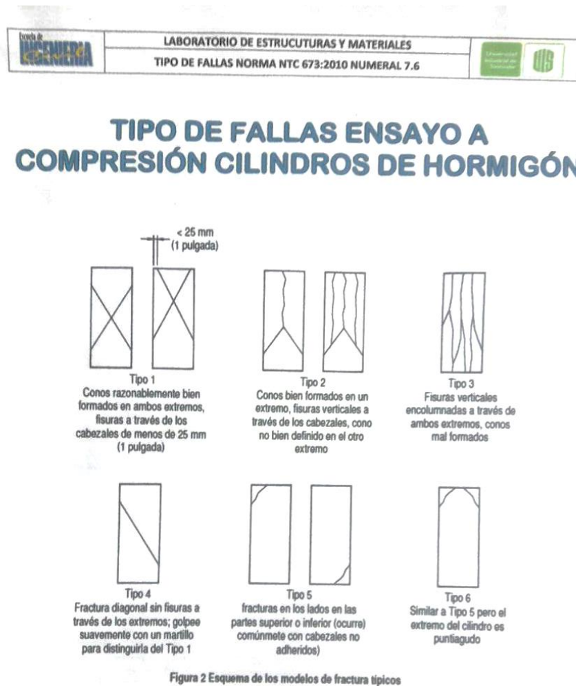
Figura 21. Tipos de fallas en ensayo de compresión simple.
